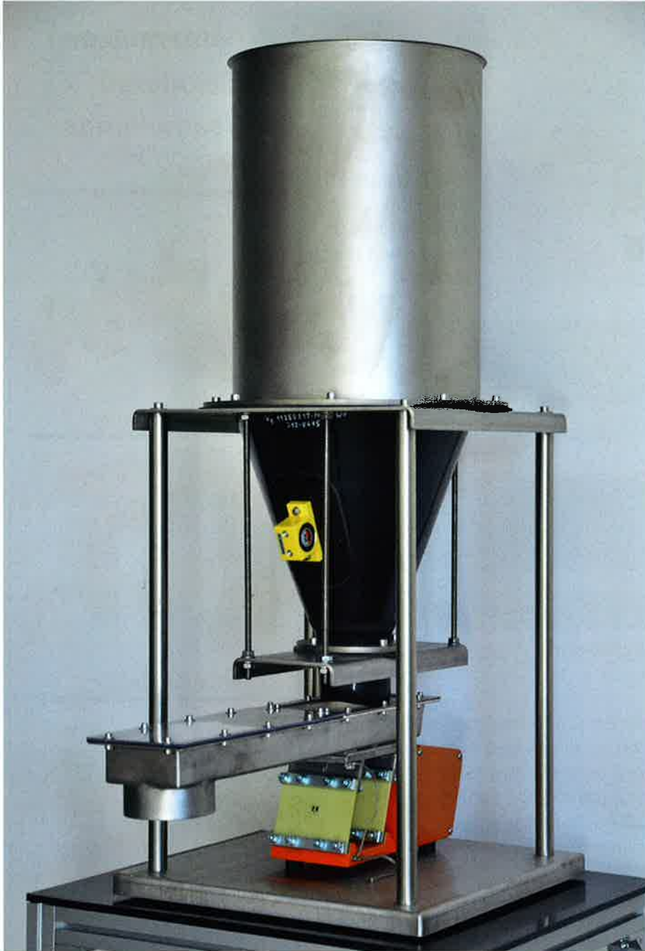
Dosiergeräte mit dem Resonanzantrieb AF14 können auch für ATEX Zonen konfiguriert werden.
